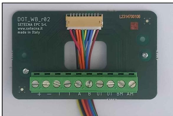
C. Mettere il retro del DOT\_WB\_10P e della placca bianca posteriore del display a contatto (rimuovere dalla placca il preforato centrale). Agganciare grazie alle viti il DOT\_WB\_10P alle asole della placca di modo che resti ad essa fissato. Far passare il cavo all'interno del foro.
